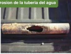
Corrosión de la tubería del agua
