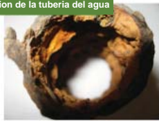
Corrosión de la tubería del agua
